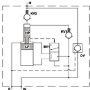
Базовая гидравлическая схема мини-мультиликатора давления
