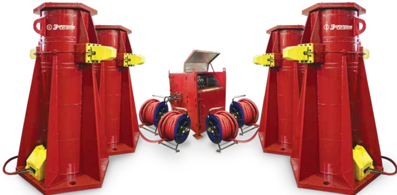
■ Комплекс гидравлический КГПЭ4-100 предназначен для подъема, удержания и опускания тяжелых объектов, например, поворотной платформы карьерного экскаватора при проведении плановых и экстренных ремонтов в полевых условиях, на месте производства горных работ.
