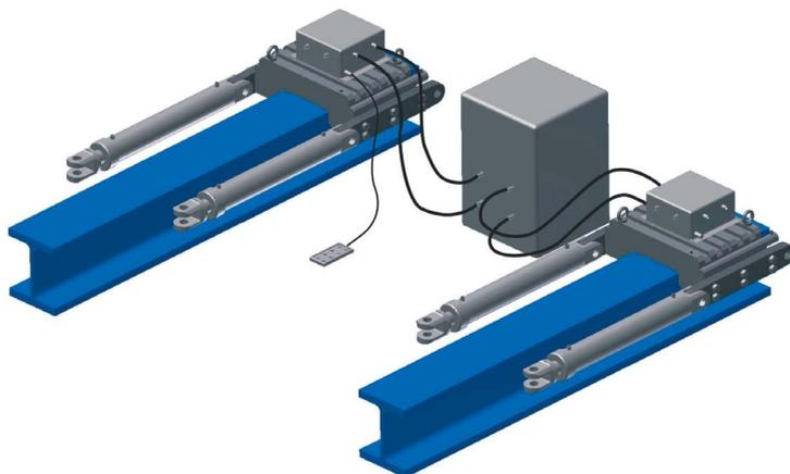
■ Применение двутавровых такелажных балок и сдвоенных силовых гидроцилиндров в конструкции толкателей обеспечивает устойчивость объекта перемещения без применения специальных фиксирующих средств, облегчает применение разнообразных устройств скольжения.
