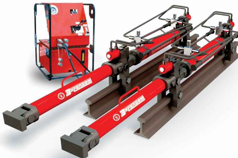
■ Основные составные части системы из двух толкателей: два силовых гидроцилиндра с гидравлическим возвратом поршня с зацепом удержания на штоках гидроцилиндров с гидроцилиндрами зажима, зацепом упора на доньшках гидроцилиндров с гидроцилиндрами зажима, насосная станция, рукава высокого давления с быстроразъемными соединениями.
