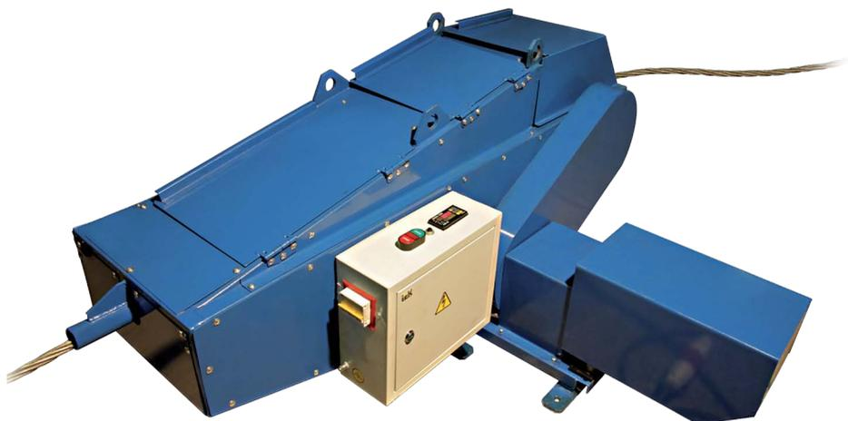
Установка ПКК-3300 предназначена для заправки пряди длиной до 250м в каналобразователь в системе преднапряжения канатной арматуры с сцеплением с бетоном.
