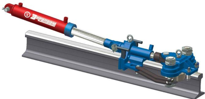
■ Система включает два эксцентриковых толкателя, специальную 2-х-портовую насосную станцию, рукава высокого давления с быстроразъемными соединениями. Применяется на рельсах типа Р65. Основные составные части толкателя: силовой гидроцилиндр с гидравлическим возвратом поршня; эксцентриковый зацеп упора с клиновой вставкой; гидроцилиндр управления зацепом; съемный башмак на кронштейне на донышке силового гидроцилиндра.
