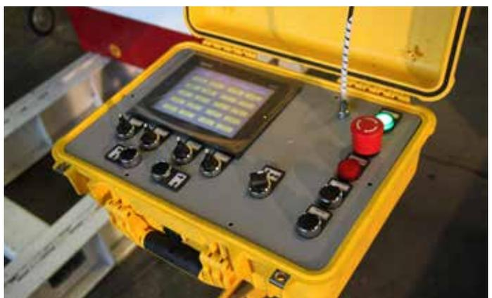
Для опускания груза в случае отсутствия электроэнергии, отказа гидросистемы, или системы управления служит аварийный пульт управления, соединенный со стойками посредством кабелей. Электропитание аварийного пульта осуществляется от аккумуляторов напряжением 24В (в комплект поставки не входят).
