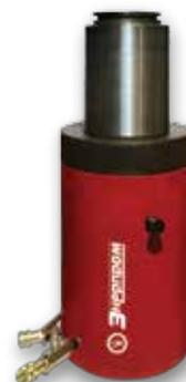
■ С пружинным и гравитационным возвратом с фиксирующей гайкой, усилие 30-1000 тс и с гидравлическим возвратом - 100-500 тс
